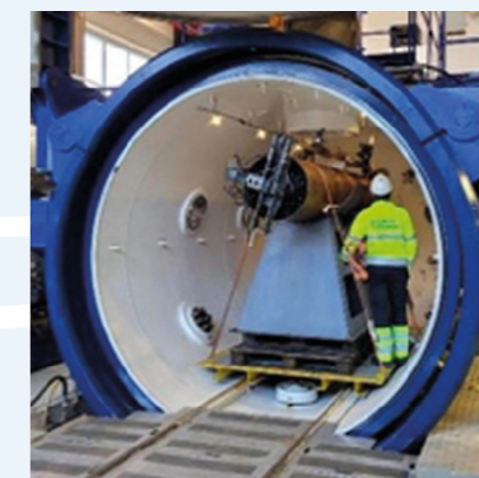
Un pull test en enceinte sous pression en azote.
