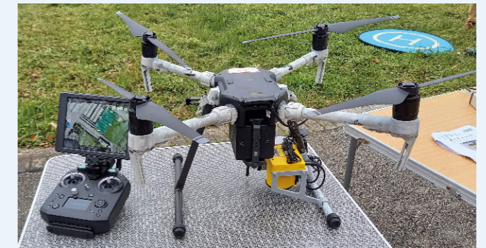
Le capteur Falcon, d'un poids de 300 g, peut être embarqué par un simple drone pour une détection jusqu'à 30 m d'altitude.
