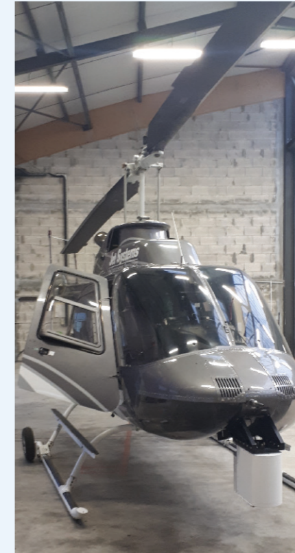
Le capteur Alma G4 (Aerial Laser Methane Assessment) transporté par hélicoptère, détecte les fuites jusqu'à 300 m d'altitude.
