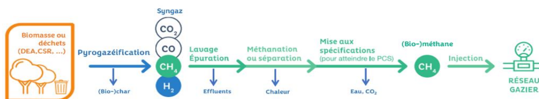
Figure 1 : Procédé de pyrogazéification pour injection
