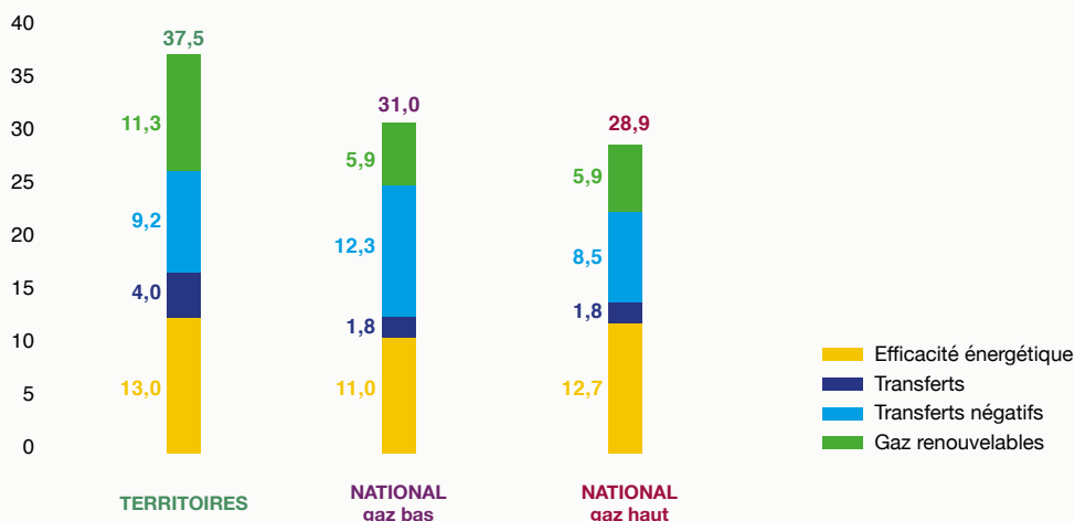
Agrégation des émissions évitées en MtCO 2 eq en 2030 par rapport à la trajectoire tendancielle sans efficacité énergétique ni substitutions
