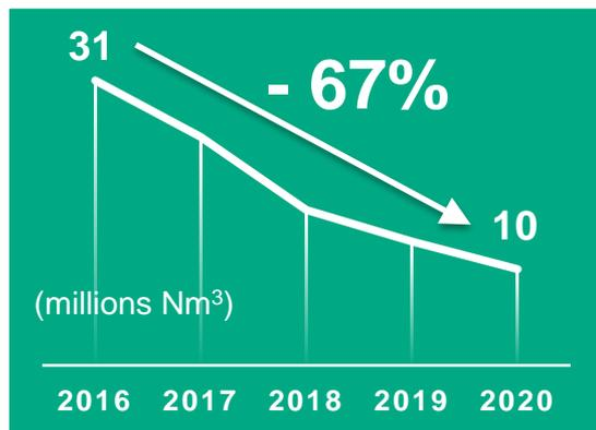
Une réduction des émissions de méthane de GRTgaz déjà significative grâce à la réduction des émissions dans les phases travaux et grâce à la détection et réparation des micro-fuites.
