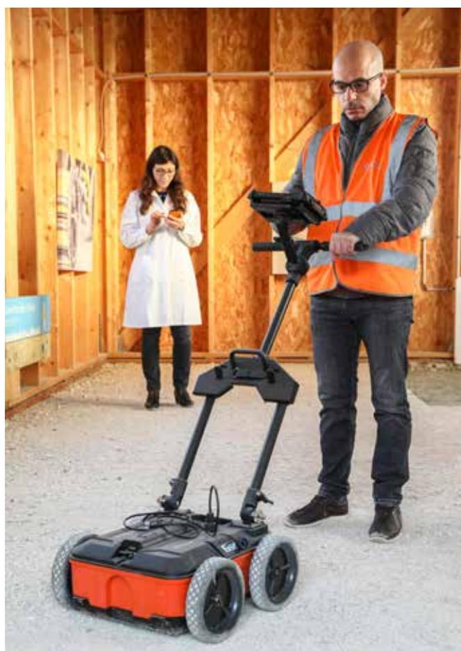
Détection de canalisations dans l'aire d'essais de RICE
