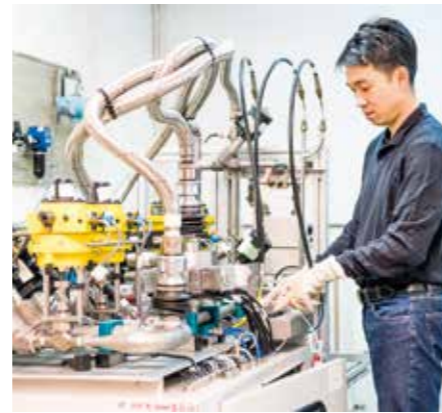
Banc d'étalonnage de compteur de distribution - pôle performance et sécurité industrielle.
